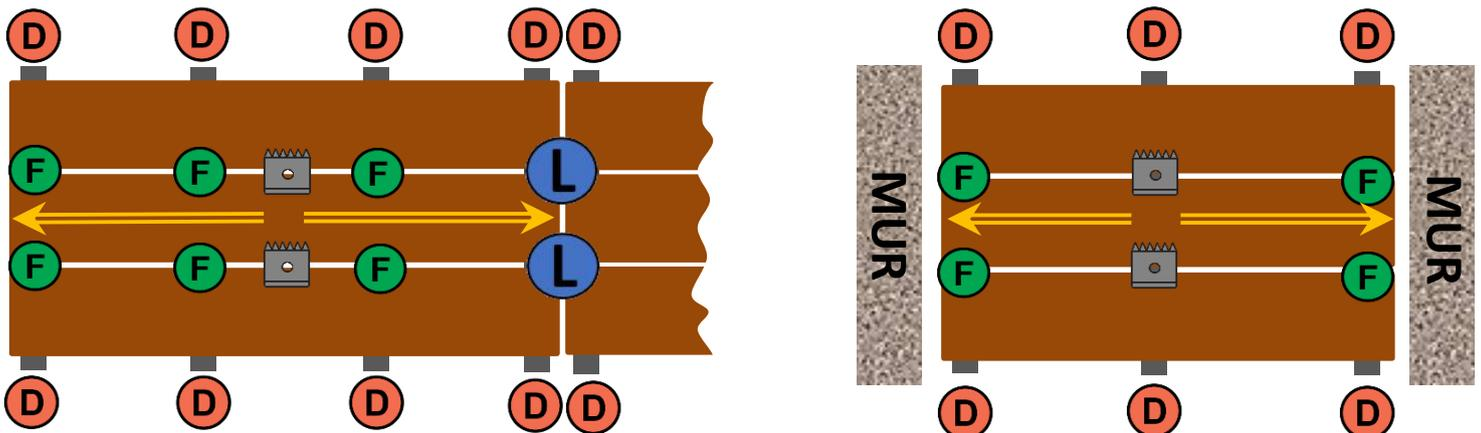
**Cas de figure B :** s'il y a un mur seulement d'un côté, alors il faut placer les clips de blocage le plus près du mur.
