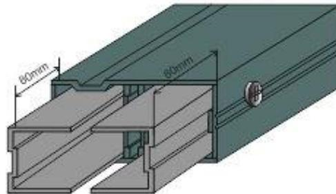
Etape 3: Insérer la lambourde structurale aluminium suivante dans les 2 prolongateurs/connecteurs en laissant 1 jeu de 5 mm entre les 2 lambourdes
