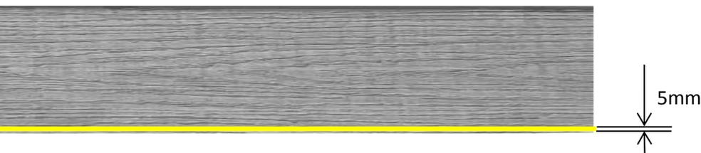
Etape 4: Fixer le profil de finition en aluminium sur la lambourde avec une vis TCB Pozi INOX 3,5x40mm
