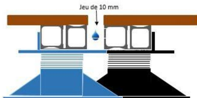
Pour le double lambourrage réalisé avec des lambourdes structurales aluminium la pose des plots en plastiques réglables doit se faire en décaler comme sur les dessins ci-dessus afin de respecter les 10 mm entre les 2 lambourdes structurales aluminium.
