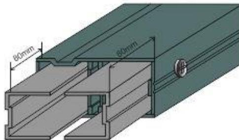
Etape 3: Insérer la lambourde structurelle aluminium suivante dans les 2 prolongateurs/connecteurs en laissant 1 jeu de 5 mm entre les 2 lambourdes
