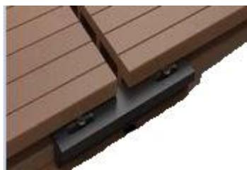
La fixation des lames composites EXTRUBOIS sur le double lambourrage réalisé avec les lambourdes structurales aluminium se fait OBLGATOIREMENT avec le clip de double lambourrage
