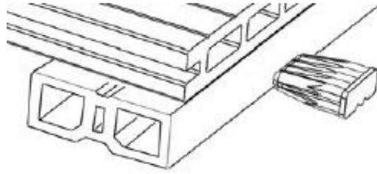
Enfin, insérer le bouchon dans l'alvéole jusqu'à ce que celui-ci arrive à fleur en bout de lame de la manière suivante :
