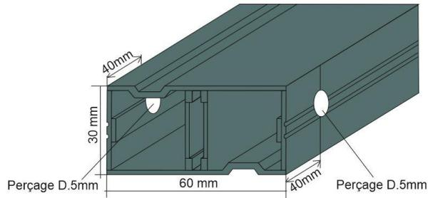
Etape 2: Insérer les 2 prolongateurs/connecteurs dans la lambourde structurelle aluminium en laissant une partie visible de 80 mm – Pour fixer les 2 prolongateurs/connecteurs utiliser les 2 vis inox fournies. Visser avec un embout PZ2 les 2 vis Inox auto perçante de part et d’autre de la lambourde structurelle aluminium.
