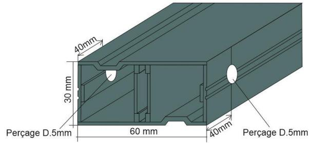
Etape 2: Insérer les 2 prolongateurs/connecteurs dans la lambourde structurale aluminium en laissant une partie visible de 80 mm – Pour fixer les 2 prolongateurs/connecteurs utiliser les 2 vis inox fournies. Visser avec un embout PZ2 les 2 vis Inox auto perçante de part et d'autre de la lambourde structurale aluminium
