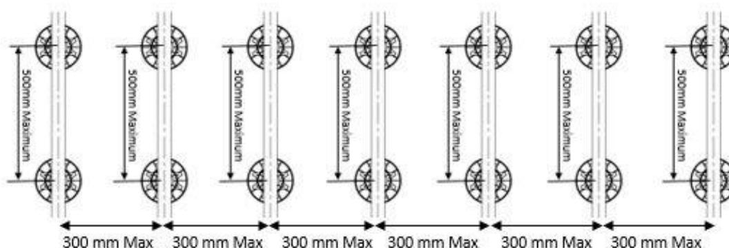
La jonction de 2 lambourdes structurelles aluminium doit se faire OBLIGATOIREMENT sur l'axe d'un plot plastique réglable. L'utilisation des 2 prolongateurs connecteurs visés sur l'une des lambourdes structurelles aluminium EST OBLIGATOIRE. Les 2 Prolongateurs/connecteurs + 2 vis inox auto perçante sont fournis et insérés dans chaque lambourde structurelle aluminium. Un jeu ou espace de 5 mm doit également être laissé entre les deux (2) lambourdes structurelles aluminium.
