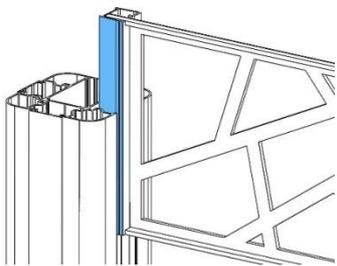
**Étape 2:** placer la tôle avec ses profils de fixation dans la gorge des poteaux de clôture EASYCLAUSTRA comme indiqué sur le schéma à gauche.
