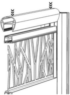
**Étape 3:** glisser la main courante dans la gorge de chaque poteau jusqu'à ce qu'elle soit au contact du long profil de fixation. Ensuite, il faut bloquer la main courante sur le profil de fixation en appuyant fortement sur celle-ci jusqu'à ressentir un clic distinct (voir schéma à gauche). Pour finir, il faut bloquer les tasseaux en les vissant comme indiqué dans le guide de montage pour clôture EASYCLAUSTRA.
